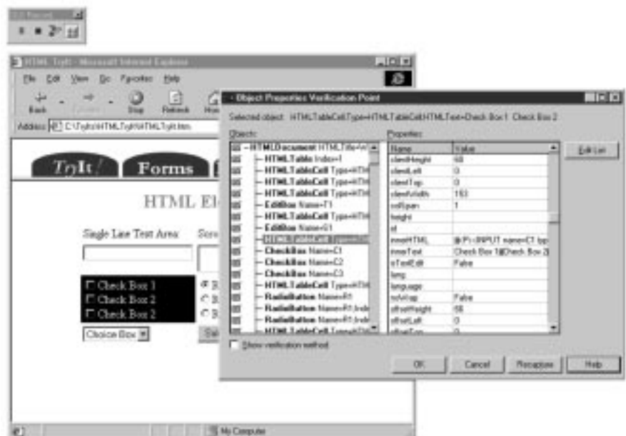
IBM Rational Robot 可擷取所有 HTML 與 DHTML 屬性，包括連結目標及隱藏的資料。
